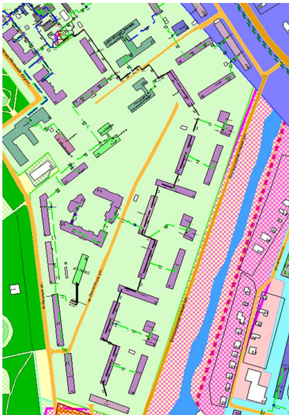
Рисунок 3.77 – Трассировка теплопровода от котельной АО «Теплоэнерго» по ул. Энгельса, д. 1В до конечного потребителя «ПТ-Больш,7»
