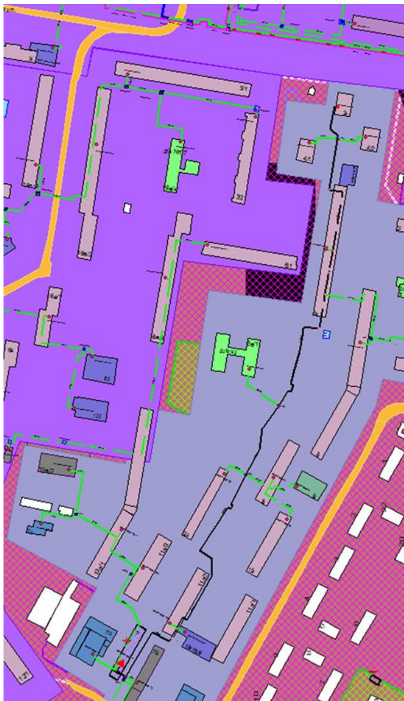
Рисунок 3.109 – Трассировка теплопровода от котельной ООО «Генерация тепла» по ул. Мончегорская, д. 11 до конечного потребителя «ПТ-Мончегорская,2а»
